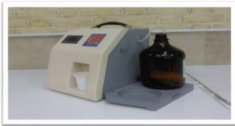
شکل ۵: نمونه بهینه سازی شده دستگاه توزیع شربت متادون
